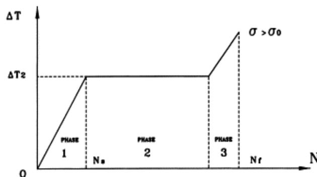
Figura 1: Incremento qualitativo della temperature in funzione del numero di cicli per una tensione sopra il limite di fatica  $\Delta\sigma_0$ .
