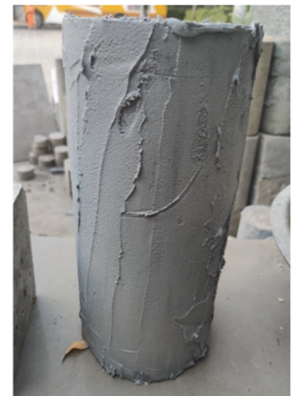
(d) Final layer of adhesive
